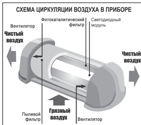
Технология обеззараживания и очистки воздуха на основе фотокатализа состоит в следующем: воздух под действием вентилятора попадает на пылевой фильтр, очищается от пыли, после этого поступает на фотокаталитический фильтр, представляющий собой пористый носитель с нанесенным на него фотокатализатором, облучаемый источником УФ излучения.
