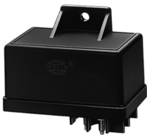
12 V, Polanzahl 6, nachglühfähig, Vorglühzeit bei +20°C / < 7 sec 4RV 008 188-111 Fiat
