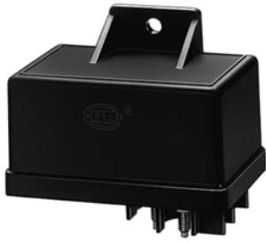
12 V, Polanzahl 6, Vorglühzeit bei +20°C / < 8 sec 4RV 008 188-091 Citroën, Fiat, Peugeot, Renault, Seat, Talbot
