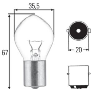
Für F2 Arbeits- und Nebelscheinwerfer, Nebelschluss- und Rückfahrleuchten
