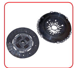
Beispiel einer durchgebrannten Kupplung
