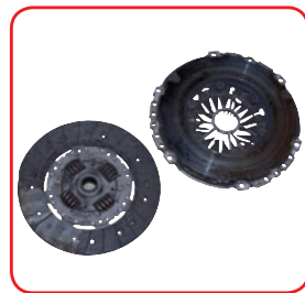
Exemple of a „burned“ clutch
