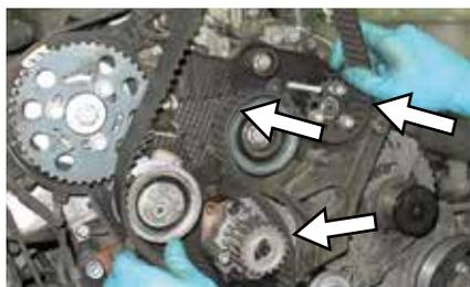
**19.** Alcune pompe acqua hanno ingranaggi ed alberi scanalati come presa di moto; assicurarsi del buono stato delle
