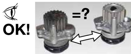
9. Se la **pompa ha una guarnizione, metallica o di altro tipo, la pasta sigillante non va assolutamente utilizzata**; la guarnizione fornita con la pompa è adeguata per garantire una perfetta tenuta.
