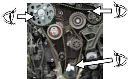
7. Una volta che la pompa è stata rimossa, si deve **pulire molto bene la superficie del basamento motore** da residui di pasta sigillante, pezzi di guarnizione rimasti incollati, riportando la superficie metallica perfettamente pulita, sgrassata ed asciutta.
