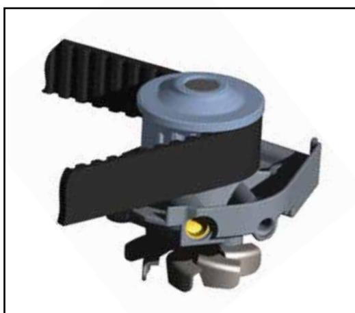
3.1 Pompa acqua con presa di moto sui denti della cinghia motore
