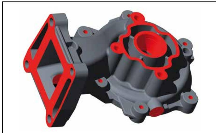
8.8 Modello 3D di un corpo pompa acqua
