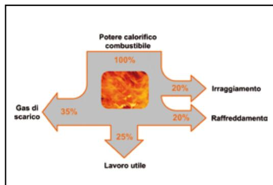
1.2 Rendimento motore a combustione interna
