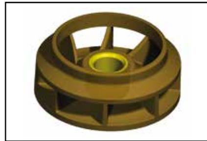
8.2 Modello 3D di una girante per pompa acqua
