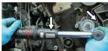
13. Rispettare scrupolosamente i valori di coppia di serraggio delle viti indicate dalla casa costruttrice.
