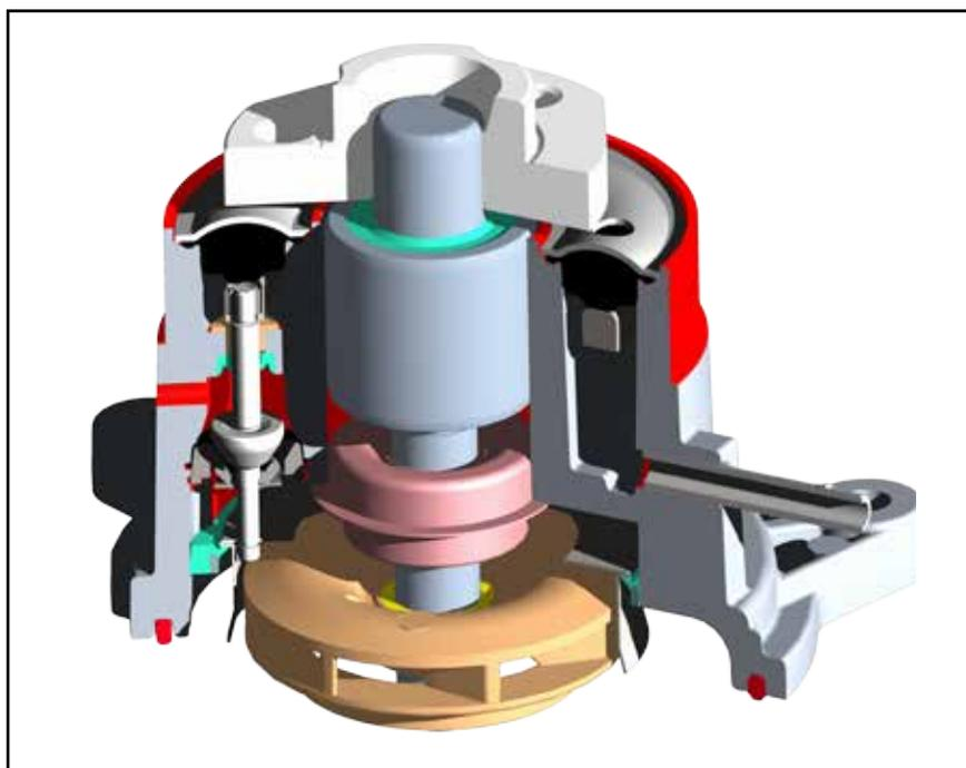
12.1 Sezione della pompa acqua azionabile brevettata da Metelli
