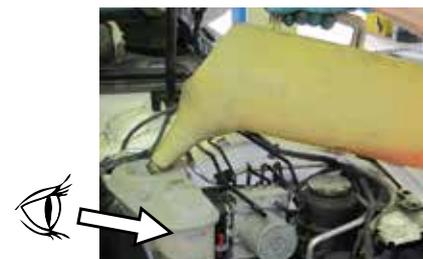
**27.** Accendere il motore e, lasciato al minimo, accendere il riscaldamento abitacolo e continuare a rabboccare il liquido refrigerante dal punto più alto del circuito (generalmente il vaso di espansione) fino a che il livello non cala più, attendere l'apertura del termostato in modo da riempire correttamente anche il radiatore.
