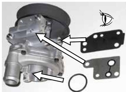
12. Le viti di fissaggio vanno avvitate incrociate e, prima di serrarle completamente, **ci si deve assicurare che la pompa sia centrata correttamente e possa girare liberamente** nella sua sede.
