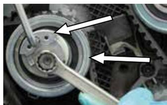
**25.** Per controllare la tensione della cinghia **utilizzare strumentazioni appropriate** che siano in grado di fornire dati certi sul valore di tensione applicato.
