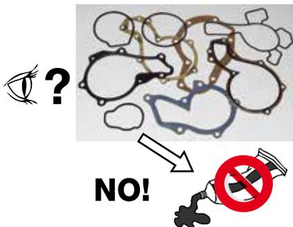
nuta, curare bene la pulizia della superficie di montaggio sul basamento motore.
