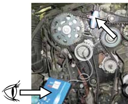
**26.** Una volta installata la pompa e sigillato nuovamente il circuito, provvedere ad un suo primo riempimento con un liquido refrigerante conforme a quanto raccomandato dal costruttore.
