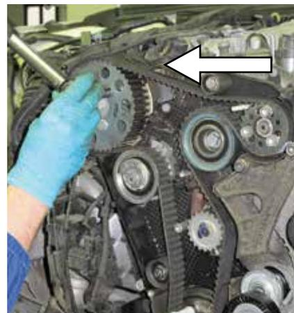
**24.** Tendere la cinghia rispettando il valore raccomandato dal costruttore; evitare tensioni eccessive, far girare il motore manualmente e verificare che
