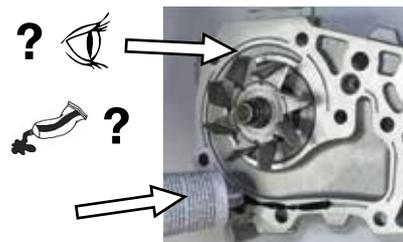
11. Ogni guarnizione che è stata smontata, va sostituita con una nuova; mai riutilizzare guarnizioni usate anche se sembrano in buone condizioni.
