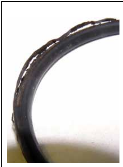
10.13 Danni causati da montaggio non corretto
