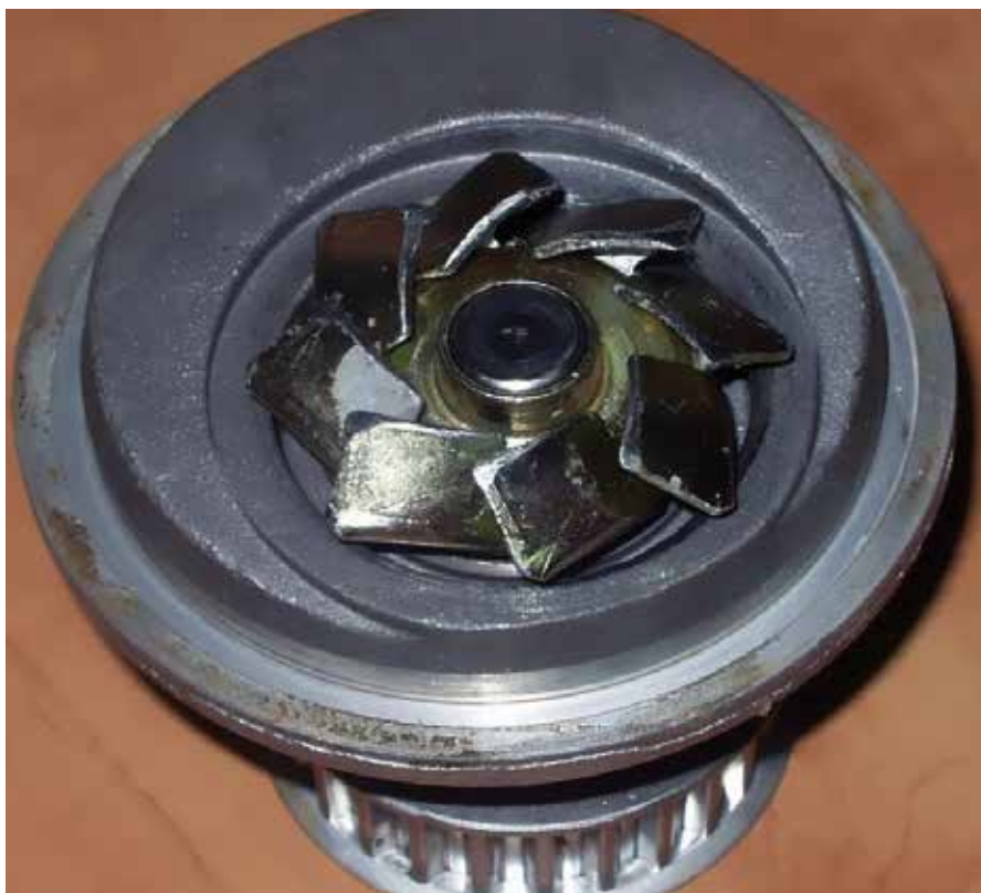
10.15 Girante danneggiata da corpo estraneo nel circuito
