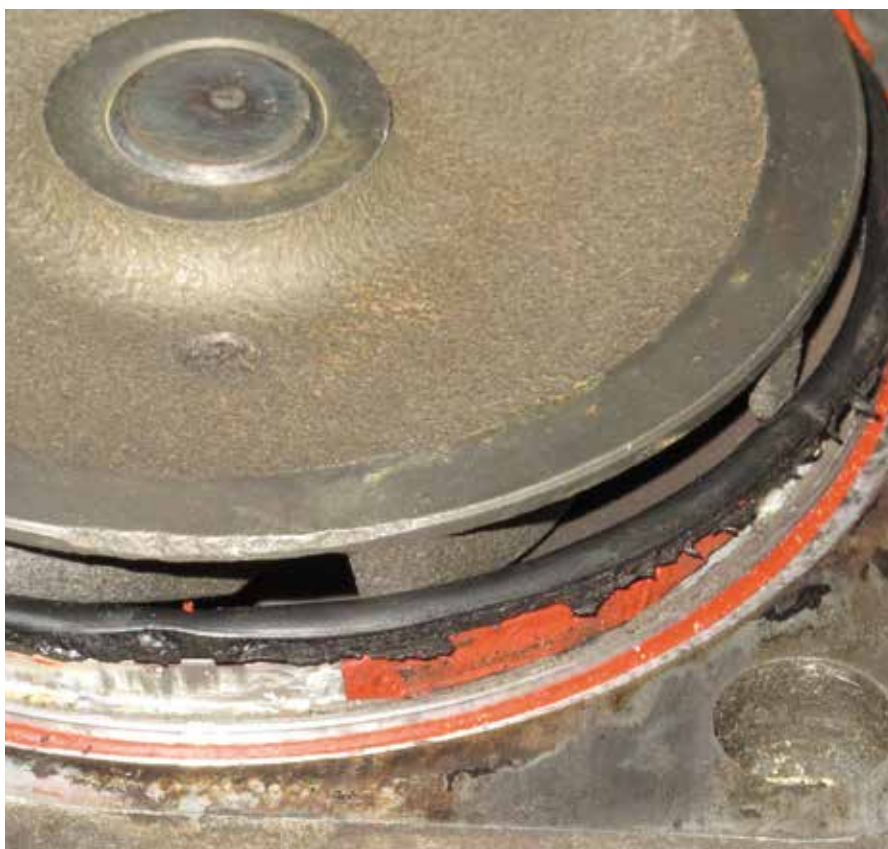
10.12 Pasta sigillante erroneamente applicata su guarnizione O-ring
