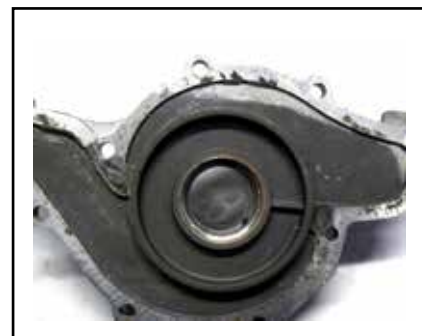
10.3 Traccia di funzionamento con una bolla d'aria presente
