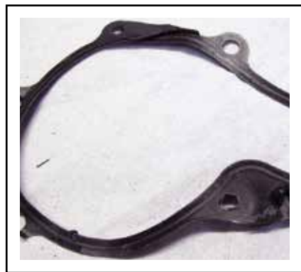
10.11 Pasta sigillante erroneamente applicata su guarnizione metallica
