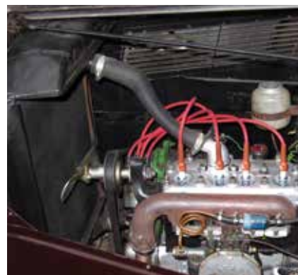
1.3 Vecchio motore privo di pompa acqua
