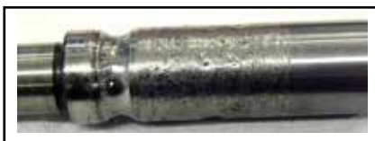
10.8 Albero cuscinetto danneggiato per carico eccessivo
