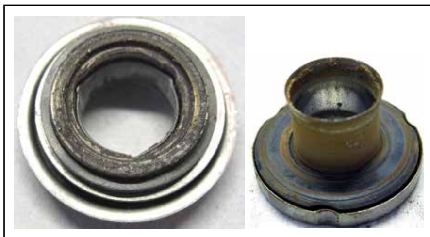
10.2 Tenute meccaniche rovinate da liquidi non idonei
