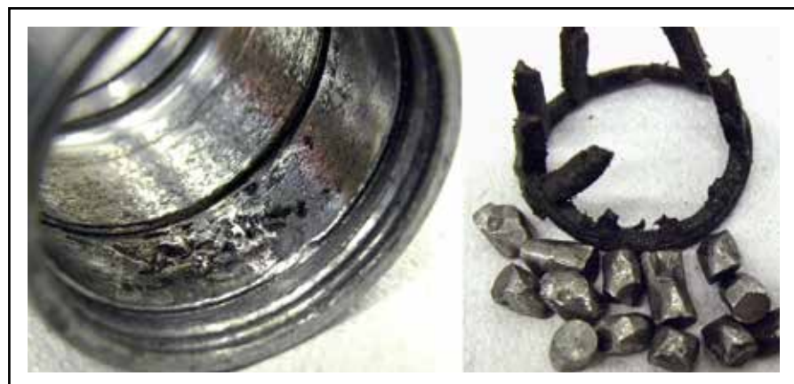
10.9 Componenti cuscinetti danneggiati per sovraccarico
