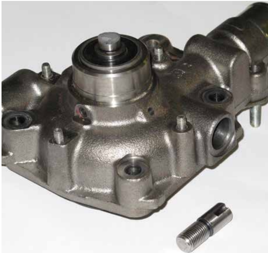
10.14 Albero cuscinetto rotto per operazioni di montaggio errate
