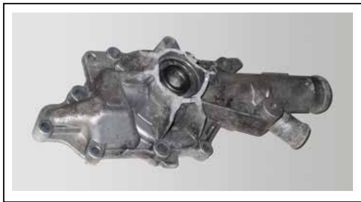
10.6 Cedimento completo del corpo pompa a causa di masse sbilanciate
