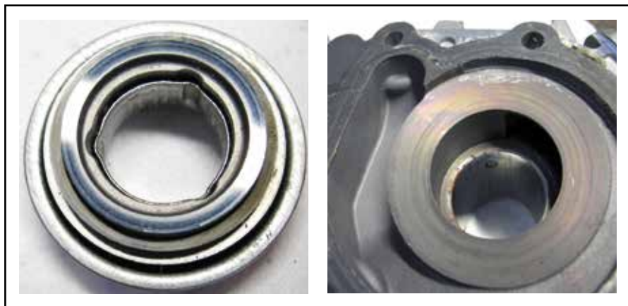
10.4 Superfici con segni di surriscaldamento
