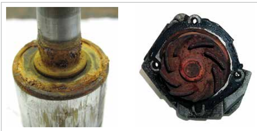
10.1 Componenti arrugginiti a causa di liquidi non idonei
