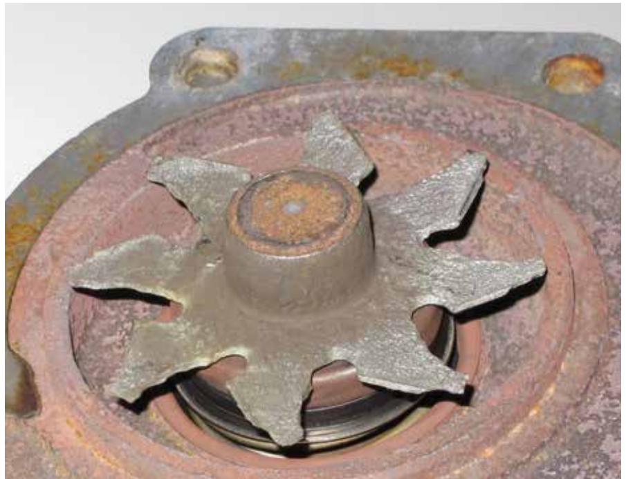
7.1 Girante completamente corrosa a causa di liquidi non corretti
