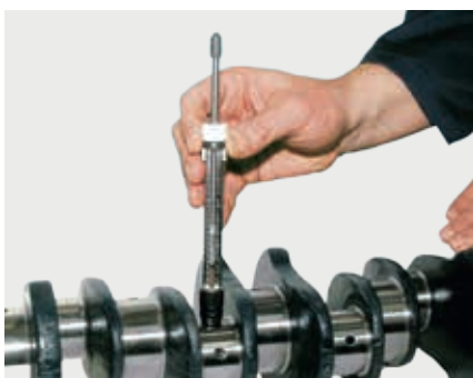
Контроль твердости склероскопом (товарный номер: 50 009 812)
