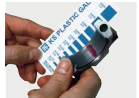
Prüfung des Gleitlagers mit „KS Plastic Gauge“
