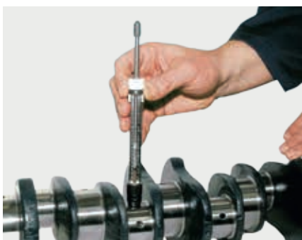
Contrôle de la dureté avec le duromètre à rebondissement (n° d'article 50 009 812)
