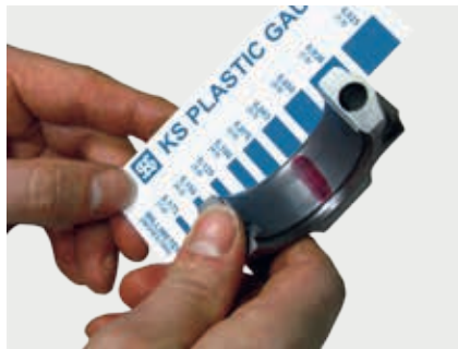
فحص المحامل الانزلاقية بأشرطة "KS Plastic Gauge"
