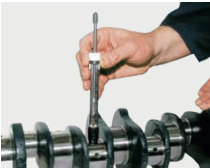
Control de dureza con el escleroscopio (Nº de art. 50 009 812)
