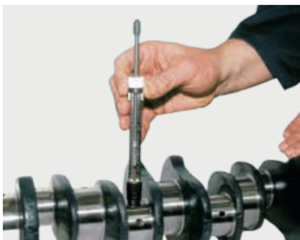
Härteprüfung mit Rückprall-Härteprüfer (Artikel-Nr. 50 009 812)
