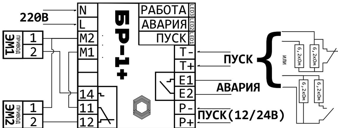
Рис. 9: Схема подключения двух электромагнитных приводов к «БР-1+».
