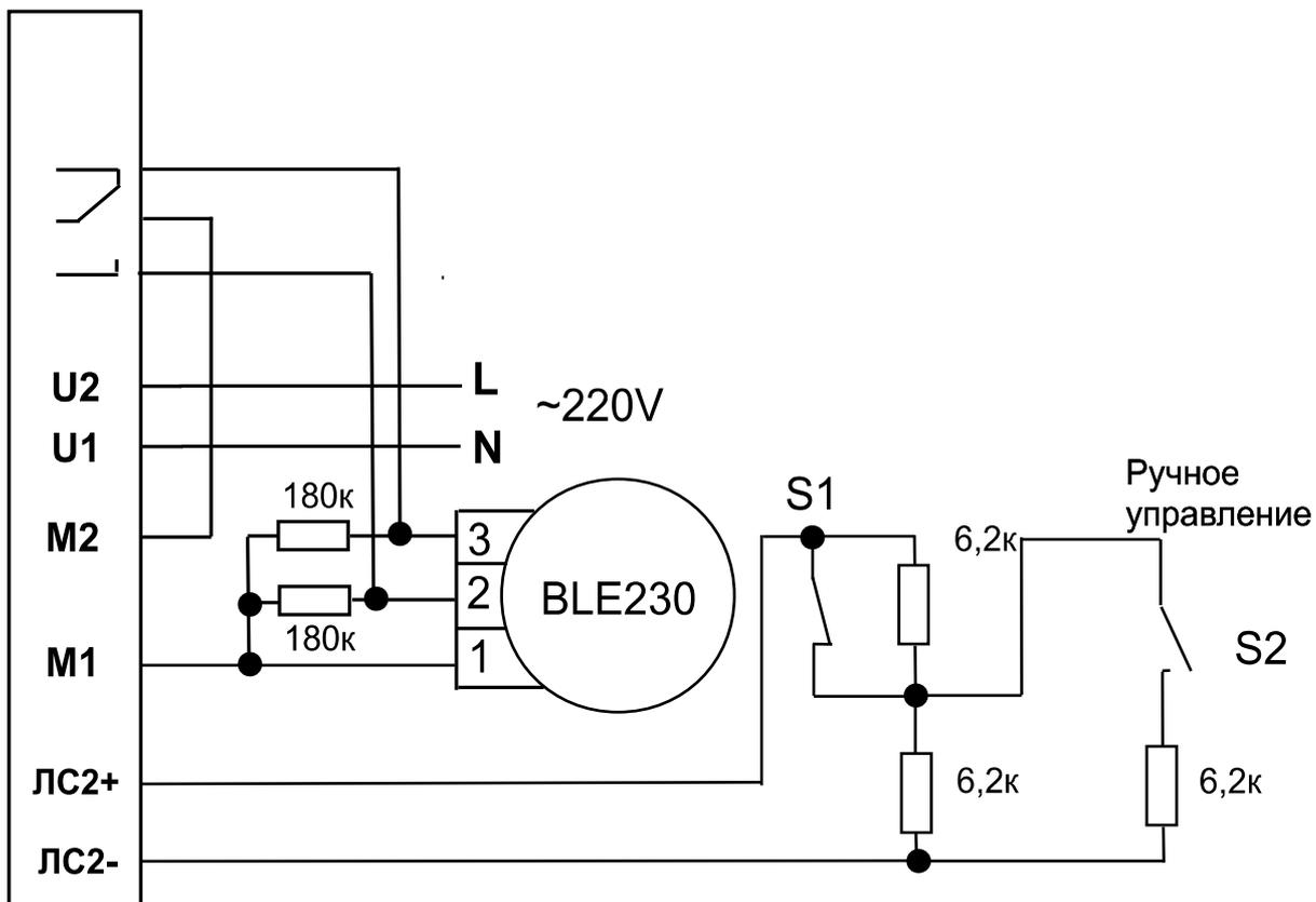
S1 — положение клапана (контакты S1, S3 привода BLE230)
