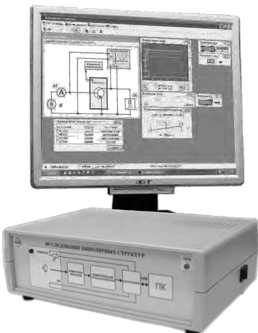
Рисунок 1. Автоматизированный лабораторный стенд для исследования биполярных структур
