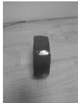
**Рисунок 1. Образец стальной трубы с теплоизоляцией из пенополиуретана при покрытии полимочевинной**
