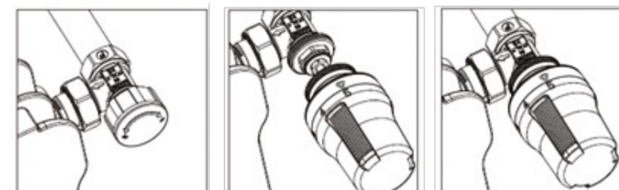
Рис.5.11. Установка термоголовки на клапан терморегулятора.
