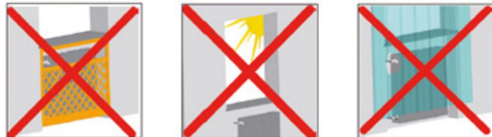
Рис.5.10. Требования по размещению автоматического терморегулятора
