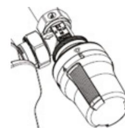
Рис.5.19. Монтажное положение термоголовки и клапана терморегулятора
