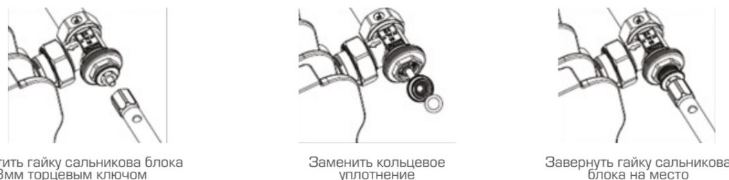
Рис.5.22. Замена кольцевого уплотнения штока клапана терморегулятора
