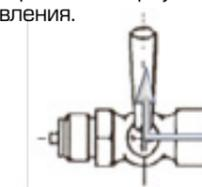
**Положение 3.** Манометр отключен. Воздух или рабочая среда выходит через боковое отверстие в корпусе крана.
