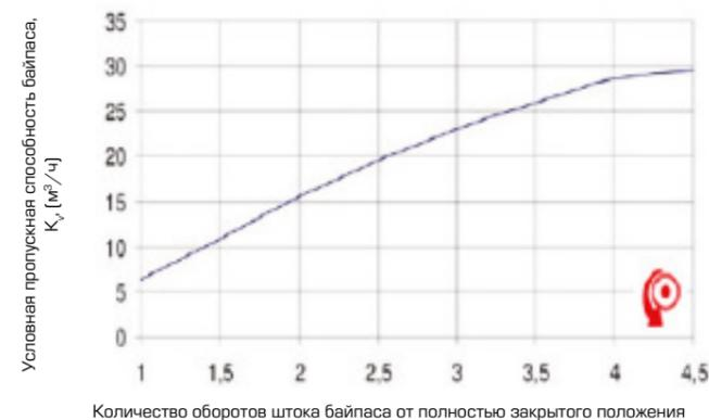
Рис.5.44. Диаграмма пропускной способности байпаса универсальной радиаторной гарнитуры в зависимости от количества оборотов его штока
