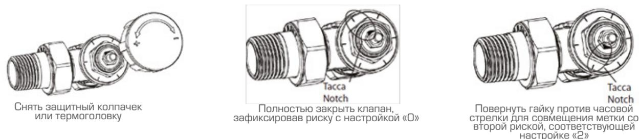
Рис.5.21. Пример преднастройки клапана терморегулятора
