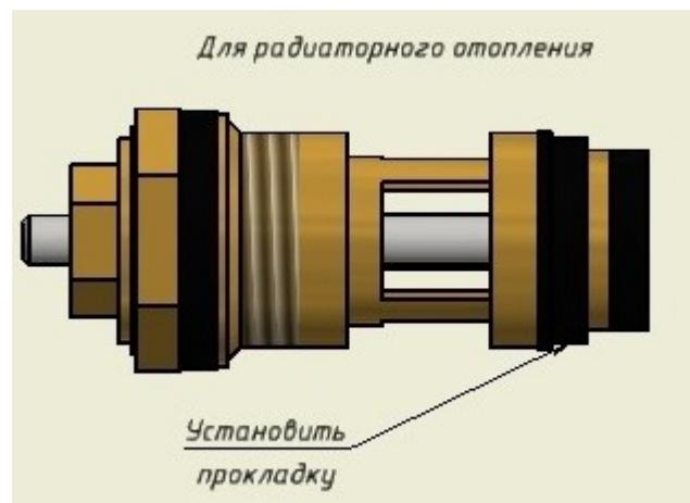
Термостатическая вставка трехходового клапана
