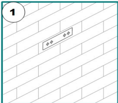
Просверлите 4 отверстия диаметром 8 мм по шаблону
