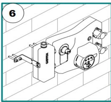
Установите переднюю крышку теплоизоляции
