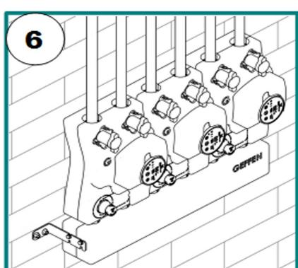
Установите переднюю крышку теплоизоляции.
