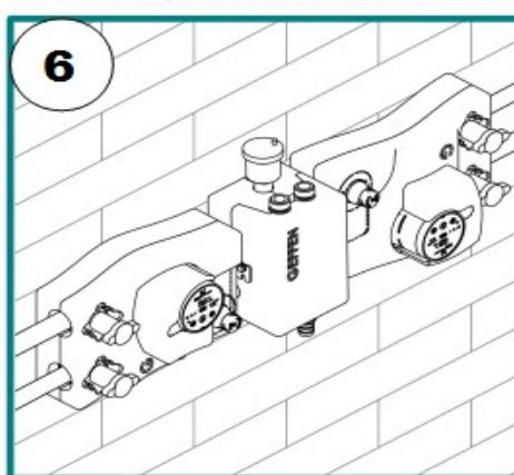
Установите переднюю крышку теплоизоляции
