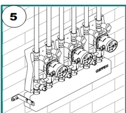
Установите задние части теплоизоляции на модули, пропустите провода от насоса и привода через отверстие в задней крышки.
