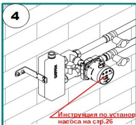
Установите модули на УНК используя накидные гайки и прокладки. Подсоедините трубопроводы. Установите электроприводы или терmostатические головки.
