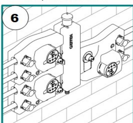
Установите переднюю крышку теплоизоляции
