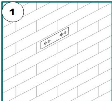
Просверлите 4 отверстия диаметром 8 мм по шаблону
