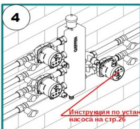
Установите модули на коллектор используя накидные гайки и прокладки. Подсоедините трубопроводы. Установите электроприводы или терmostатические головки.
