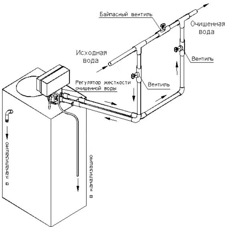
Рисунок 2 – Схема монтажа установки умягчения воды периодического действия типа “Кабинет” WSC
