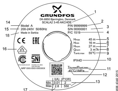
Рис. 2 Пример фирменной таблички
