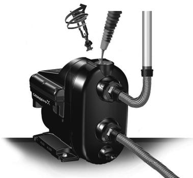
Рис. 9 Заливка насосной установки
