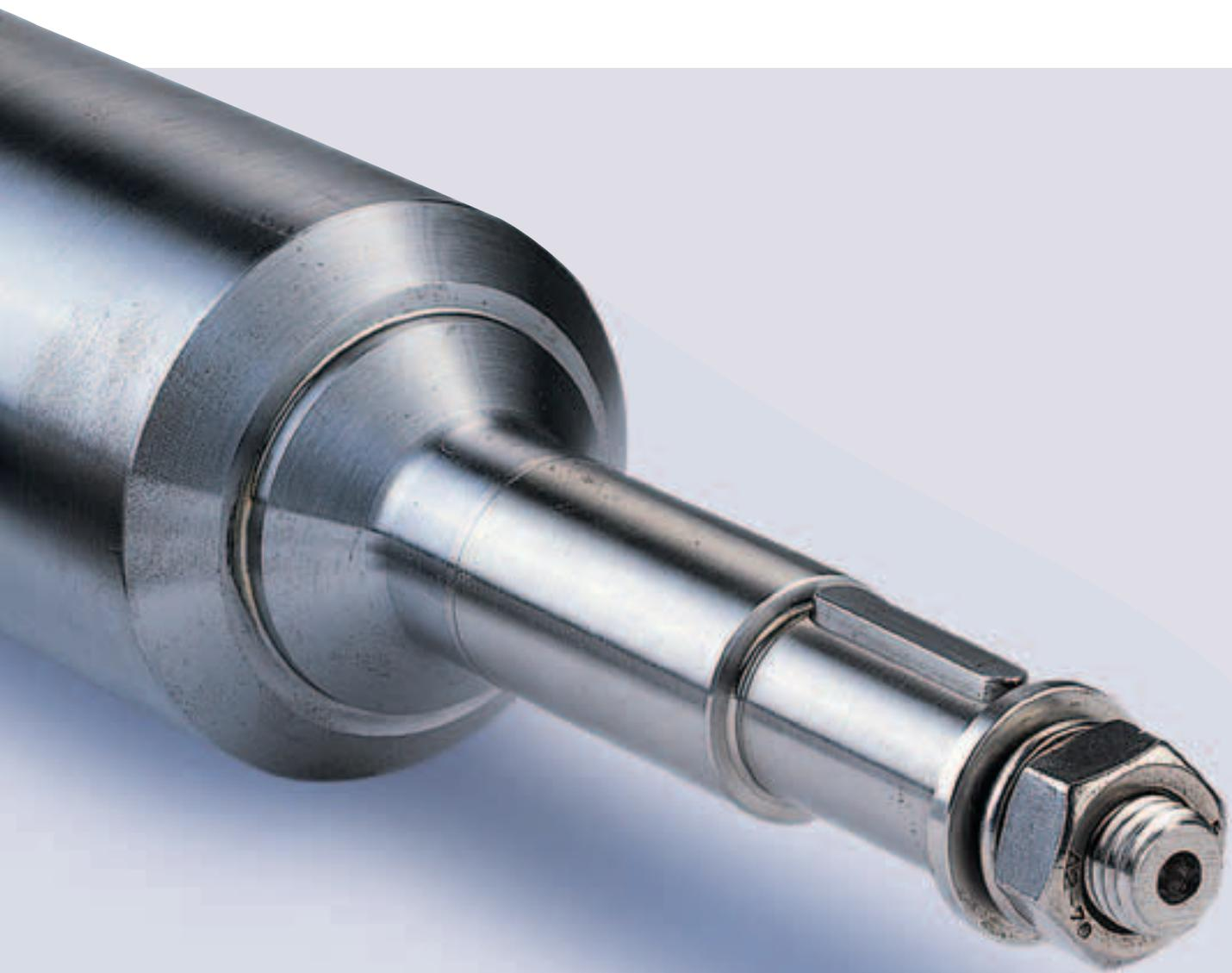
▲ Традиционно наиболее слабым местом насосов “ин-лайн” является муфтовое соединение. Плохое соединение приводит к повышенному износу не только подшипников электродвигателя, но и торцового уплотнения вала. Муфта в виде гильзы оригинальной конструкции нового насоса “ин-лайн” TP фирмы GRUNDFOS способствует решению именно этой проблемы: муфта соединяется с валом сваркой трением, образуя, таким образом, единую жесткую деталь. >
