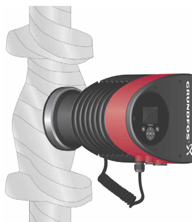
Рис. 19 Изоляция корпуса насоса и трубопровода
