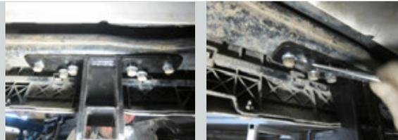
**ШАГ 4.** Установите кронштейн розетки и закрепите его на шпильке с помощью гайки М10 через шайбу М10 увеличенную и шайбу М10 пружинную.
