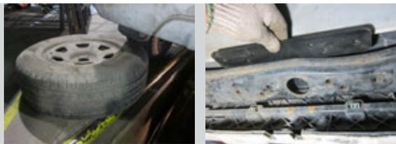
**ШАГ 2.** Для установки фаркопа совместите отверстия в сварном кронштейне с отверстиями задней балки и закладной пластины.
