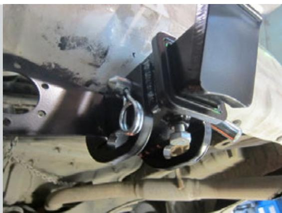
Тип шара «Е»; Тип соединения: шаровый; Диаметр сцепного шара: 50 мм.; Масса комплекта ТСУ 08031501: 9,5 кг.
