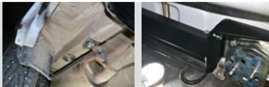
**ШАГ 3.** Установите опоры усилителя заднего бампера с помощью болтов М8х40, через шайбы гроверные на 8 и шайбы на 8. Соединения не затягивать.
