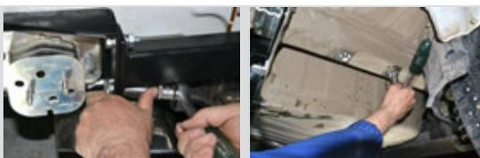
**ШАГ 5.** Установите усилитель заднего бампера на штатные метизы. Установите задний бампер и задние фонари согласно инструкции по ремонту автомобиля. Установите шар в сборе (Поз. М). Зафиксируйте шар в сборе с помощью пальца с клипсой и фиксирующего болта (Поз. С) Установка завершена.
