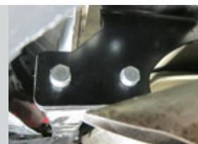
**ШАГ 5.** Установите съемный шар в сборе и закрепите его пальцем гнутым со шплинтом. Зафиксируйте съемный шар болтом М10х20 снизу. Затяните съёмный шар с помощью ключа на 38 мм. Перед установкой фартуков просверлите в них отверстия под шпильки.
