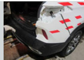
**ШАГ 4.** Установите кронштейн розетки и закрепите его на шпильке с помощью гайки М10 через шайбу 10 увеличенную и шайбу 10 пружинную. Закрепите центральный кронштейн на боковых с помощью болтов М12х1,25х40 через шайбы с помощью гаек.
