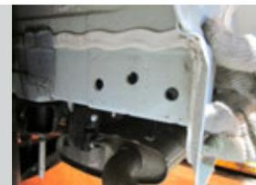
**ШАГ 3.** Установите кронштейны совместив отверстия в кронштейнах и в лонжеронах, и с закладными шпильками М8. Закрепите кронштейны с помощью болтов М12 через шайбы и гроверы. И с помощью гаек М8 через шайбы 8. Установите бампер.
