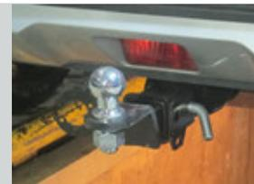
Тип шара «Е»; Тип соединения: шаровый; Диаметр сцепного шара: 50 мм.; Масса комплекта ТСУ 06071501: 17,8 кг.
