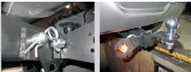
Тип шара «Е»; Тип соединения: шаровый; Диаметр сцепного шара: 50 мм.; Масса комплекта ТСУ 11031501: 17 кг.
