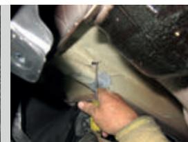
**ШАГ 2.** Удалите пластиковые заглушки с технологических отверстий с каждой стороны задних лонжеронов.
