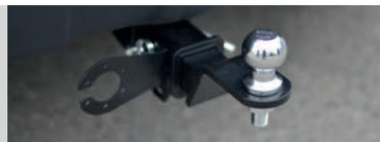
Тип шара «Е»; Тип соединения: шаровый; Диаметр сцепного шара: 50 мм.; Масса комплекта ТСУ 01501501: 13 кг.
