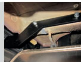
**ШАГ 4.** При необходимости подрежьте бампер с внутр. стороны. Установите центральную часть тягово-сцепного устройства прикрепив её к кронштейнам с помощью крепежных винтов из комплекта поставки. Установите шар в сборе и затяните его ключом на 32мм.
