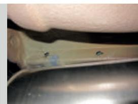
**ШАГ 3.** Проденьте сквозь лонжерон крепежные винты из комплекта поставки шляпками наружу автомобиля. Закрепите на винтах крепежные кронштейны. С помощью гаек, шайб и гроверных шайб.
