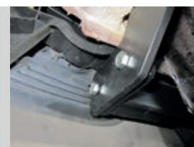
**ШАГ 5.** Установите кронштейн крепления электрической розетки, стопорный винт снизу. Верните глушитель на посадочное место. Закрепите нижнюю часть бампера штатными винтами. Установка завершена.
