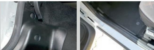
**ВНИМАНИЕ!** При ежедневной эксплуатации автомобиля (особенно в демисезонное время), на пластиковых деталях возможно появление белёсого налёта. Для предотвращения этого, после каждой мойки автомобиля рекомендуется применять средства для ухода за наружным черным пластиком, либо полироль для пластика с эффектом чернения.
