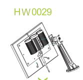
安装支架:将机器与支架从包装盒里 取出,从配件袋里找出外六角螺丝 ( 6X8MM)与扳手。支架用螺丝固 定在机器相应位置上。
