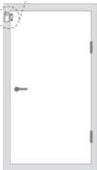
1. Убедитесь, что системный блок сигнализации, в предполагаемом месте его монтажа, принимает сигнал от датчика, который находится в предполагаемом месте его монтажа.
