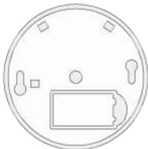
1. Установите батарейку в соответствующее отделение перед инсталляцией. После установки батареи, датчик автоматически включается и переходит в режим «БЕЗДЕЙСТВИЕ».
