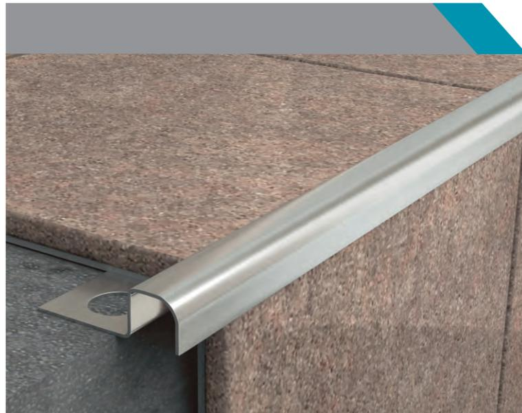
Профиль с закругленной лицевой поверхностью предназначен для отделки и защиты внешних углов, облицованных плиткой, а также для отделки торцевых кромок кафеля. Возможно использование данного профиля для оформления торцов плитки при соединении с другими видами поверхностей в роли окаймляющего бордюра.
