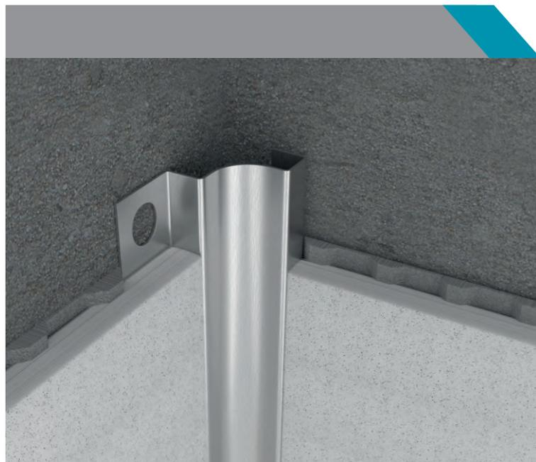
Профиль закладной односторонний для отделки внутренних углов плиточных соединений. Благодаря закругленной форме видимой части профиля формирует гладкий вогнутый внутренний угол и напоминает декоративную галтель. Используется как в вертикальной, так и в горизонтальной плоскости. Оставляет края плитки открытыми.
