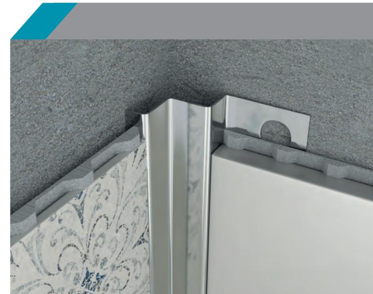
Закладной односторонний профиль для отделки внутренних углов плиточных соединений. Видимая часть профиля формирует прямой угол. Края плитки остаются видимыми. Профиль используется как в вертикальной, так и в горизонтальной плоскости, создавая красивый переход.
