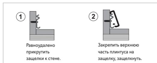
Пл 40 НС(П) - плинтус с защелкивающимся крепежом предназначен для перекрытия места стыка напольного покрытия со стеной. Имеет возможность прокладки кабеля.
