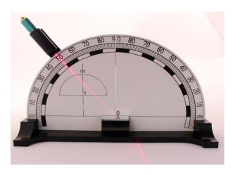
Соберите установку, показанную на рисунке. Поставьте зеркало в фиксатор и передвигайте источник света, направляя световой луч под разными углами. Получите падающий и отраженный лучи. Данные по измерению углов запишите в таблицу:
