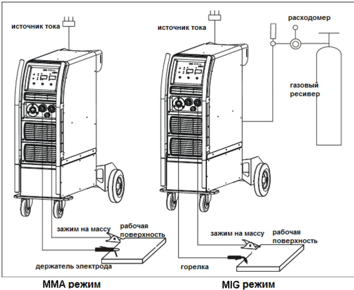
Заметка: Переключите аппарат в режим ручной сварки, чтобы подогреть газовый ресивер и предупредить замерзание газа, когда вы не работаете в режиме MIG.
