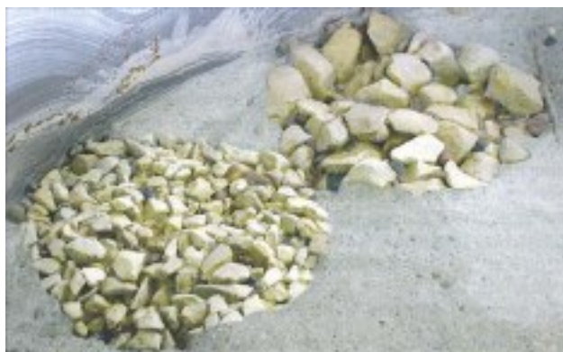
Рис. 10. Результаты испытания на износ для цилиндров из асфальтобетонного композита, базальта и ПУ-композита ДПС-2/01.
