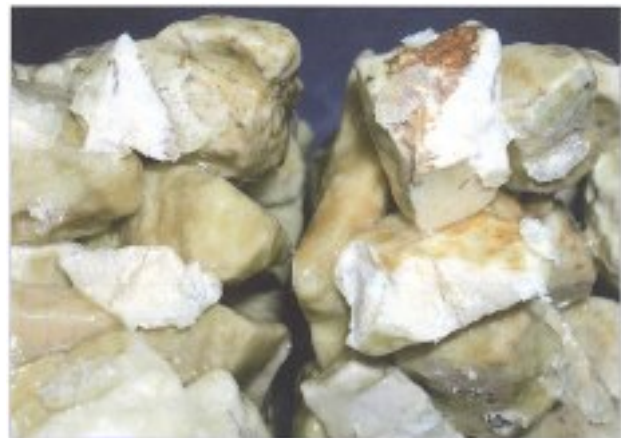
Рис. 5. Разломанные камни в поперечном сечении бруска №6 из желтого известняка, используемого в испытании на прочность при трехточечном изгибе с постоянной нагрузкой.
