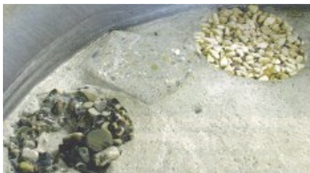
Рис. 11. Результаты испытания на износ для образцов из ПУ-композита ДПС-2/01, размеры фракций 8/11 мм и 16/32 мм.
