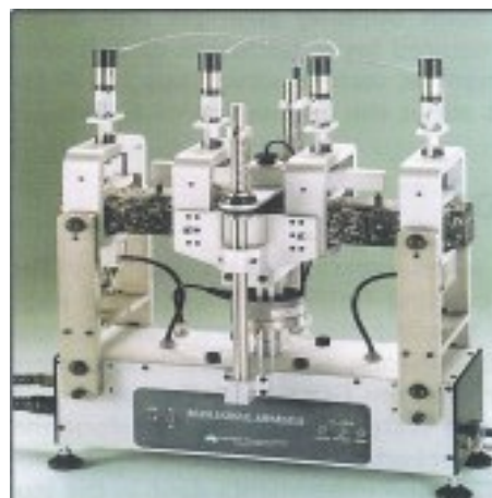
Рис. 1. Устройство для измерения четырехточечного изгиба с частотной нагрузкой.
