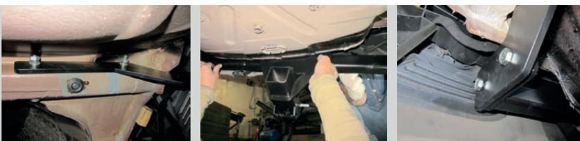
**ШАГ 5.** Установите кронштейн крепления электрической розетки, стопорный винт снизу. Верните глушитель на посадочное место. Закрепите нижнюю часть бампера штатными винтами. Установка завершена.
