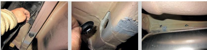
**ШАГ 3.** Проденьте сквозь лонжерон крепежные винты из комплекта поставки шляпками наружу автомобиля. Закрепите на винтах крепежные кронштейны. С помощью гаек, шайб и гроверных шайб.
