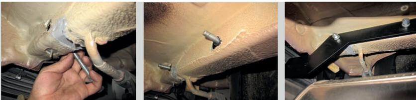
**ШАГ 4.** При необходимости подрежьте бампер с внутр. стороны. Установите центральную часть тягово-сцепного устройства прикрепив её к кронштейнам с помощью крепежных винтов из комплекта поставки. Установите шар в сборе и затяните его ключом на 32мм.
