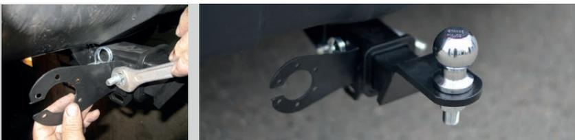
Тип соединения: шаровый; Диаметр сцепного шара: 50 мм.; Масса комплекта ТСУ 01511501: 13 кг.
