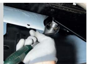
**ШАГ 5.** Установите съемный шар в сборе и закрепите его пальцем гнутым с шплинтом.
