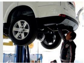
**ШАГ 2.** Выкрутите два штатных болта M12 крепления задней балки, как показано на фото. Установите кронштейн боковой на раму, совместив отверстия в кронштейне с отверстиями крепления задней балки и закрутите его входящими в комплект поставки болтами M12x45x1.25 с юбкой, но не затягивайте.
