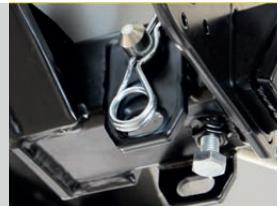
Тип соединения: шаровый; Диаметр сцепного шара: 50 мм.; Масса комплекта ТСУ 19011501: 10 кг.
