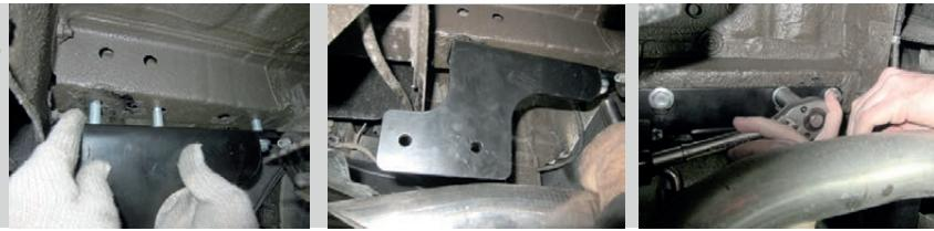
**ШАГ 3.** Установите уголок , совместив отверстия уголка с отверстиями в нижней части правого лонжерона автомобиля и соедините их с помощью болтов крепления проушины . Аналогично установите кронштейн правый и соедините его с отверстиями в на боковой части лонжерона автомобиля и с отверстиями в уголке с помощью двух болтов M10x40 , гайками M10 и гроверы M10.
