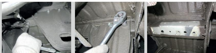
**ШАГ 2.** Установите кронштейн левый, совместив отверстия кронштейна с отверстиями в лонжероне автомобиля и соедините их с закладными пластинами с помощью болтов M10x40x1,25 через шайбы M10 и гроверные шайбы M10.
