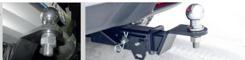
Тип соединения: шаровый; Диаметр сцепного шара: 50 мм.; Масса комплекта ТСУ 08101501: 17,9 кг.
