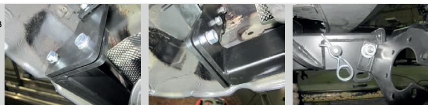
**ШАГ 5.** Затяните шар с помощью ключа на 32 мм Вкрутите стопорный винт M10x20 снизу. Установите задний бампер согласно руководства по ремонту автомобиля. Установка завершена.
