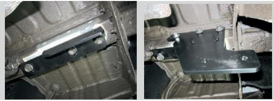
**ШАГ 4.** Установите кронштейн сварной, совместив отверстия в боковых кронштейнах с отв-ми балки и соедините их с помощью болтов M10x40 через шайбы и гроверные шайбы M10. Установите кронштейн крепления розетки, шар в сборе и зафиксируйте его шплинтом.
