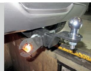
Тип соединения: шаровый; Диаметр сцепного шара: 50 мм.; Масса комплекта ТСУ 11031501: 13 кг.
