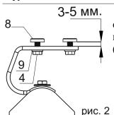
**с. наживите** гайки квадратные[8], используя винты[4], шайбы[9], оставив зазор в 3-5 мм (см. рис. 2).
