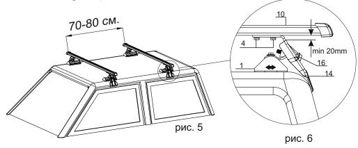
(3) Затяните попеременно болты[4] с помощью ключа. Соблюдая осторожность, отрегулируйте попеременно прижим багажника к крыше болтами[16] (см стр.1, п.4). Максимальная нагрузка на багажник «Муравей» - не более 75 кг. для четырёх дверных автомобилей, при условии, если в инструкции производителя автомобиля не указана меньшая допустимая нагрузка.
