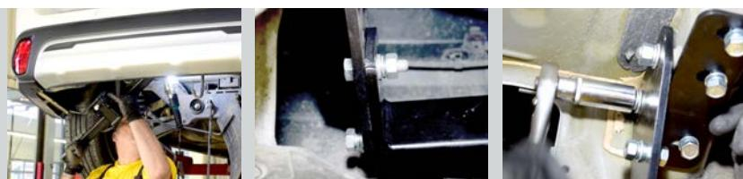
**ШАГ 5.** Установите усилитель и глушитель на место. Установите запасное колесо на место. Установите съемный шар в сборе и закрепите его пальцем гнутым со шплитом. Зафиксируйте съемный шар болтом M10x20. Установка завершена.
