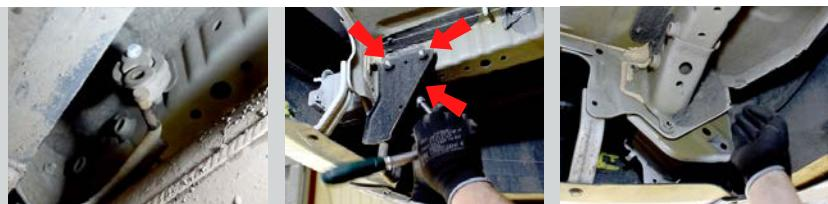
**ШАГ 2.** Установите кронштейн боковой и прикрутите его с помощью болтов M12x110x1,25 продетых сквозь лонжерон, гайками M12x1,25 через шайбы M12 и шайбы пружинные M12. Кронштейн устанавливается с внутренней стороны лонжерона гибом в центр автомобиля.
