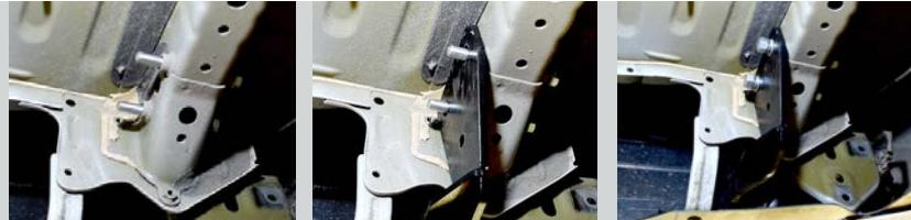
**ШАГ 3.** Установите пластиу гнутую и прикрутите её к лонжерону с помощью болтов M10x40x1,25 через шайбы M10 и к кронштейну с помощью болта M10x30x1,25 через шайбы M10 с двух сторон, шайбы пруж. M10 и гайки M10x1,25. Повторите шаги 2-3 для другой стороны.
