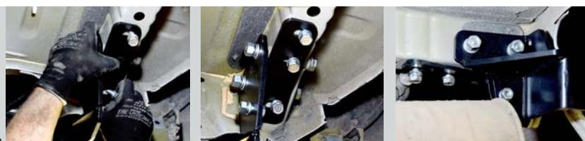
**ШАГ 4.** Для установки фаркопа совместите отверстия в сварном кронштейне с резьбовыми отверстиями кронштейнов и соедините всё с помощью болтов M10x30x1,25, через шайбы M10, шайбы пружинные M10 и гайки M10x1,25. Затяните все резьбовые соединения.
