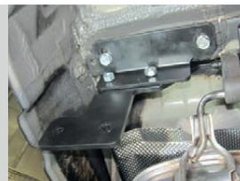
**ШАГ 3.** Установите кронштейн левый, совместив отверстия кронштейна с отверстиями в лонжероне автомобиля и соедините их с закладными пластинами с помощью болтов М10х40 через шайбы и гроверные шайбы М10.
