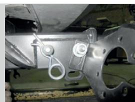
**ШАГ 5.** Затяните шар с помощью ключа на 32 мм. Вкрутите стопорный винт М10х20 снизу. Установите задний бампер согласно руководства по ремонту автомобиля. Установка завершена.
