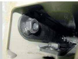
**ШАГ 2.** Установите кронштейн правый, совместив отверстия кронштейна с отверстиями в лонжероне автомобиля и соедините их с закладными пластинами с помощью болтов М10х40 через шайбы и гроверные шайбы М10. Аналогично установите уголок (поз.1).
