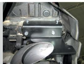
**ШАГ 4.** Установите кронштейн сварной, совместив отверстия с отверстиями в боковых кронштейнах и соедините их с помощью болтов М10х40 через шайбы и гроверные шайбы М10. Установите кронштейн крепления розетки, шар в сборе и зафиксируйте его шплинтом.
