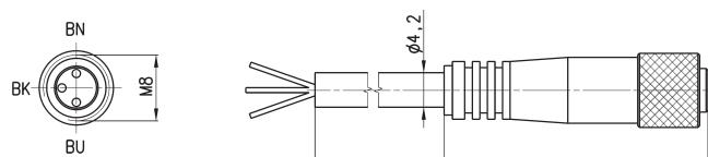
В случае, использования 2-х проводного датчика с разъемом M8 (CST-250N, CSV-250N и CSH-253), соедините коричневый провод с "+" источника питания, а черный с нагрузкой.
