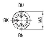
При изменении полярности подключения датчик сохраняет работоспособность, но светодиод включаться не будет.
