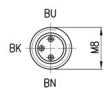
При изменении полярности подключения датчик сохраняет работоспособность, но светодиод включаться не будет.
