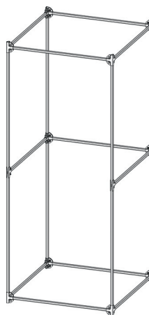
Рисунок 12 – Предварительная фиксация конструкции верхнего уровня
