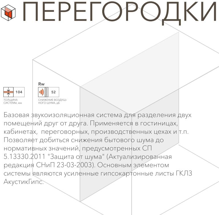
Базовая звукоизоляционная система для разделения двух помещений друг от друга. Применяется в гостиницах, кабинетах, переговорных, производственных цехах и т.п. Позволяет добиться снижения бытового шума до нормативных значений, предусмотренных СП 5.13330.2011 "Защита от шума" (Актуализированная редакция СНиП 23-03-2003). Основным элементом системы являются усиленные гипсокартонные листы ГКЛЗ АкустиКГипс.
