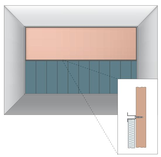
4 Устанавливаем второй ряд панелей, заводим верхний край панели под L-профиль и опускаем ее в U-профиль.
