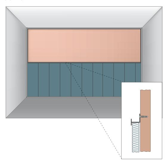
4 Устанавливаем второй ряд панелей. Сначала заводим панель под верхний профиль, затем опускаем в нижний.
