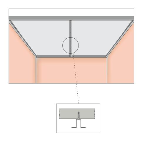
Устанавливаем панели, вставляя их сначала в L-профиль и потом задвигаем в U-профиль.
