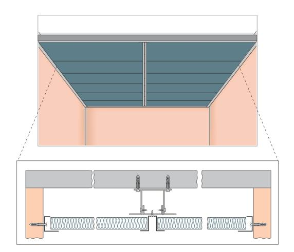
Фиксируем направляющий профиль L в углах на вытяжные заклепки.
