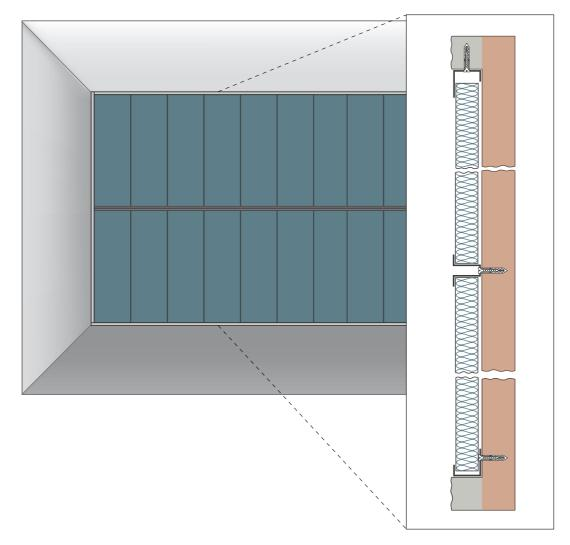
Фиксируем направляющий профиль L в углах на вытяжные заклепки.
