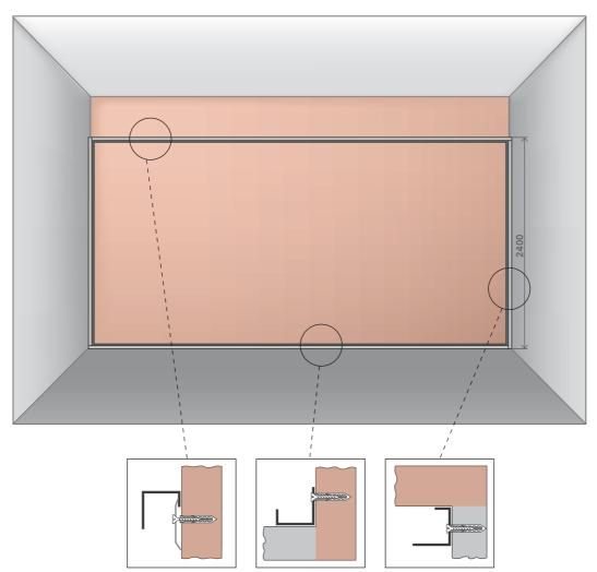
Устанавливаем панели. Сначала заводим панель под верхний профиль, затем опускаем в нижний.
