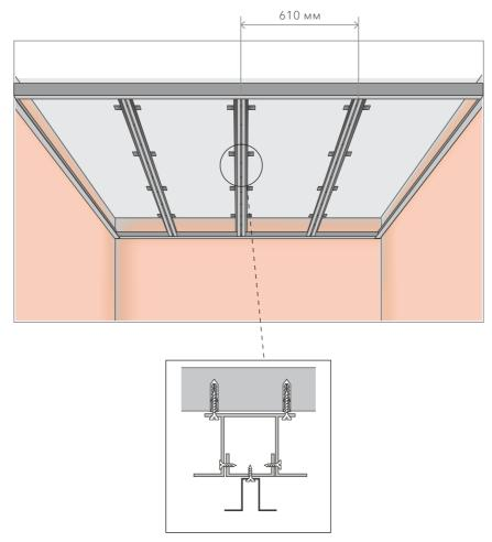
Устанавливаем панели, вставляя их сначала в L-профиль и потом задвигаем в U-профиль. Делаем то же самое для панелей, находящихся между двух U-профилей.
