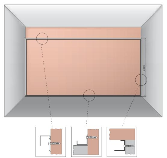
2 Устанавливаем панели. Сначала заводим панель под верхний профиль, затем опускаем в нижний. После установки первой панели крепим U-профиль и продолжаем последовательность для следующих панелей.
