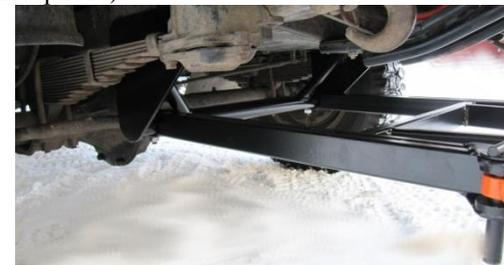
3.5. Установите боковой упор угла отвала на отвале с помощью малого пальца и выставите необходимый угол.
