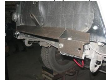
3.4. Закрепите навеску на кронштейне крепления (с удлинителем для УАЗ-2206 «Санитарка», без удлинителя для УАЗ-3151 «Хантер» и УАЗ-3163 «Патриот»).
