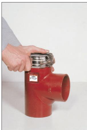
1. Поставляемый в комплекте соединительный элемент насадить на край трубы до среднего распорного кольца уплотнения
