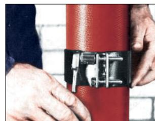
5. Оба зажимных винта затянуть попеременно, равномерно и сильно. Направляющие пластины и пластины с резьбой замка должны сходиться параллельно, для того чтобы предотвратить возникновение деформации.
