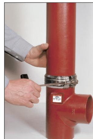
3. При помощи торцевого ключа, динамометрического ключа или импульсного винтовёрта прочно затянуть винт с внутренним шестигранником, по возможности до соединения обоих зажимных кулачков
