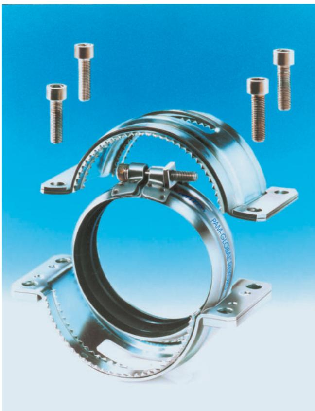
Обе половинки хомута должны равномерно обхватить край трубы. Для этого половинки хомута сначала нужно свободно свинтить между собой и следить за тем, чтобы края зажима фиксирующего хомута не захватывали металлический кожух уплотнительного хомута. Затем попеременно перекрёстно затянуть винты, для того чтобы запорные элементы затягивались параллельно и по возможности с одинаковым зазором. Кроме того необходимо следить за безупреч-
