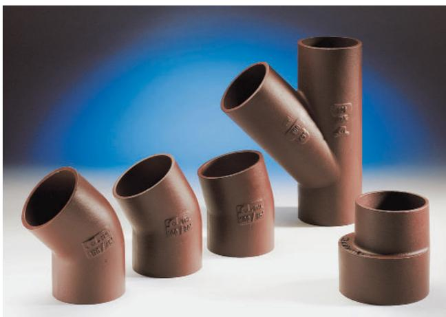
Фасонные части PAM-GLOBAL® C погружаются в сильно насыщенную цинковой пылью эпоксидную смолу. Как и при покрытии труб, цинковая пыль берёт на себя выполнение задачи активной и пассивной защиты от коррозии.
