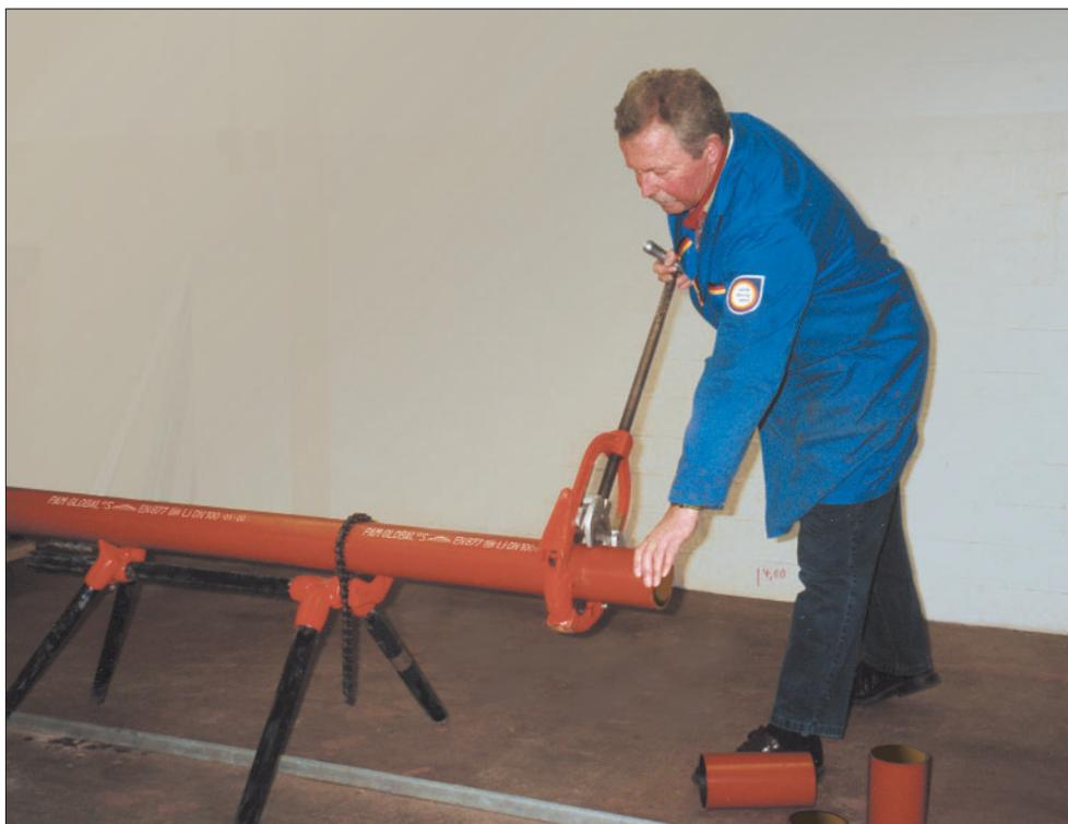
Трубы PAM-GLOBAL® до DN 300 поставляются длиной в 3 м и нарезаются по размеру. Для этого предлагаются напр. труборезы фирмы Ridgid (рисунок сверху) или Virax, которые позволяют производить быструю, чистую и прямоугольную нарезку. Угловые шлифовальные машины с отрезными кругами для
