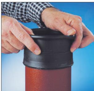
1. Соединительный элемент Rollfix надевается на гладкий конец таким образом, чтобы трапециевидное юстировочное кольцо наложились на торцовый край трубы. Шланговая муфта выступает над краем трубы.
