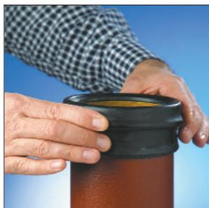
3. Теперь выступающая над трубой часть уплотнительного элемента собирается в гармошку двумя руками на гладком конце, и образующийся передний выступ вставляется в раструб.
