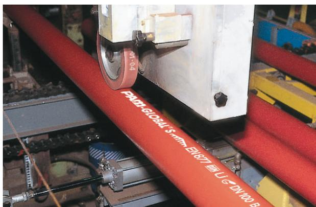
Чугунные трубы фирмы SAINT-GOBAIN HES GmbH поставляются с этой маркировкой, причём обозначения PAM-GLOBAL® S и DN варьируются, например PAM-GLOBAL® C, DN 200 и т.п.
