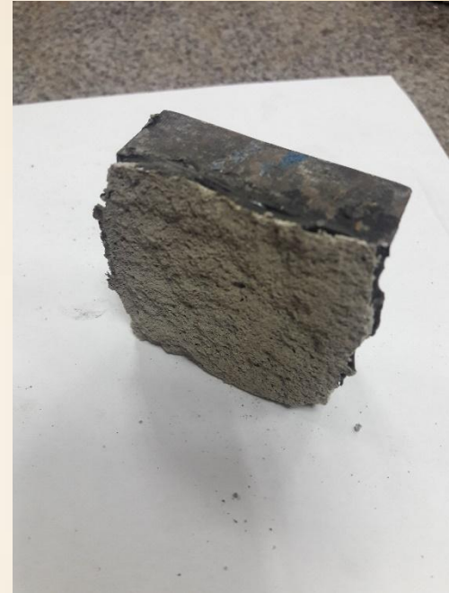
Поверхности лицевого кирпича и испытательного штампа, свидетельствующие о когезионном отрыве (по телу материала)
