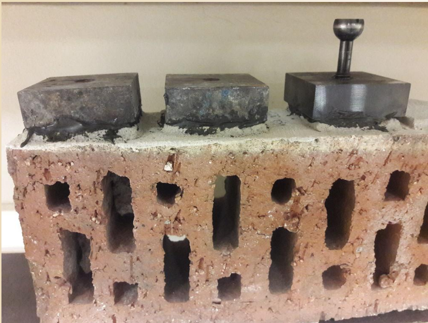
Подготовленные к испытанию на прочность сцепления с поверхностью лицевого кирпича образцы цементно-известковой штукатурки
