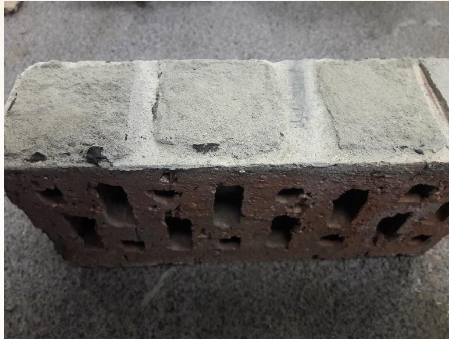
Поверхности лицевого кирпича и испытательного штампа, свидетельствующие о когезионном отрыве (по телу материала)
