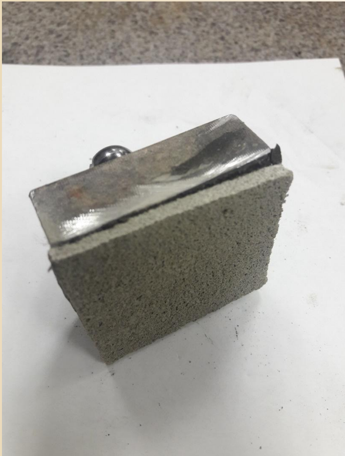
Поверхности испытательного штампа, свидетельствующие об отрыве штукатурно-клеявого состава по адгезионному контакту
