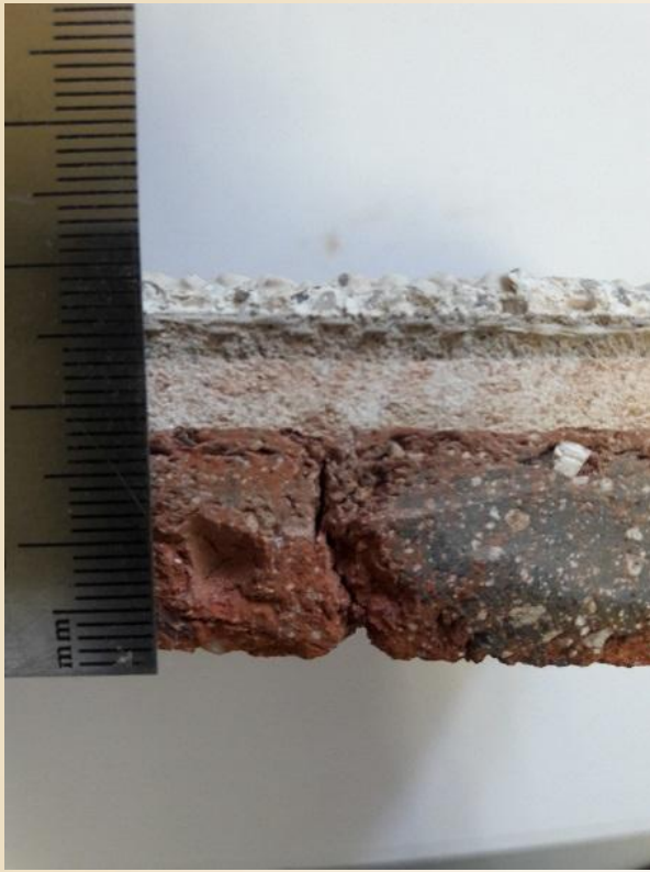
Многослойный образец отделки фасада г. Пушкин, ул. Глинки, д.4 (ремонт фасада с применением штукатурно-клеявого состава)
