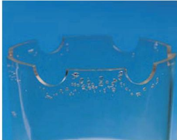
Рис. 6.1: Пустоты в конце течения потока стаканчика
