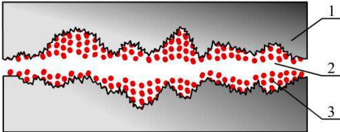
1 – металлическая поверхность детали; 2– смазочный материал; 3– «сервовитная» плёнка.
