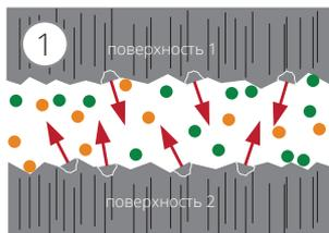
В процессе трения, при определенных условиях, происходит отрыв частиц поверхности деталей.
