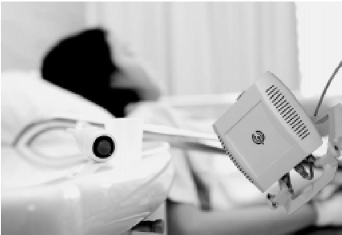
Датчики присутствия НаноПульс видят человека даже в том случае, если он не совершает никаких механических движений. Достаточно лишь того, чтобы человек дышал, т.е. «был живым», – и датчик незамедлительно обнаружит его по движению грудной клетки. Поскольку движение грудной клетки вызвано дыханием человека, то датчики присутствия, настроенные на обнаружение и регистрацию движения грудной клетки, называются датчиками дыхания. Датчики запатентованы в России, США и некоторых странах Евросоюза.
