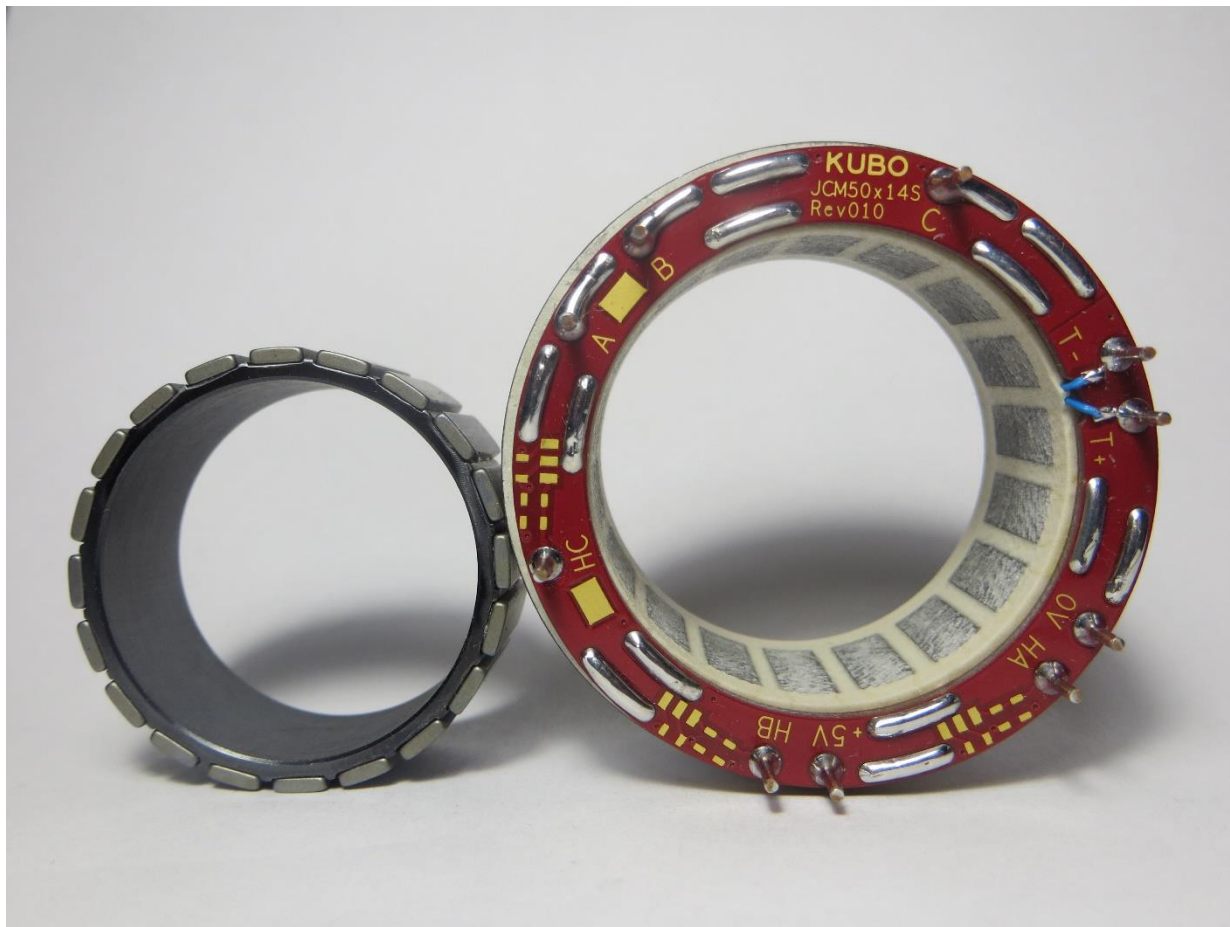
Ротор и статор JCM50x14S
