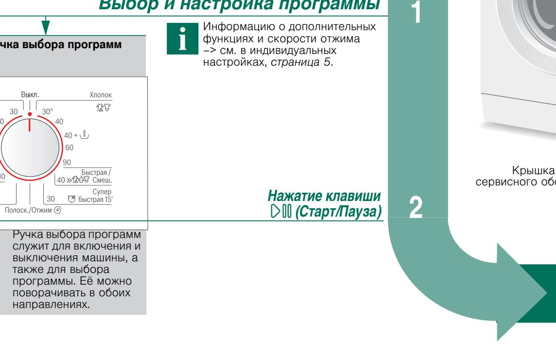
**i** Все клавиши являются высокочувствительными – для их активизации достаточно легкого прикосновения! При продолжительном прикосновении к кнопке установки скорости отжима срабатывает автоматический просмотр опций настройки!
