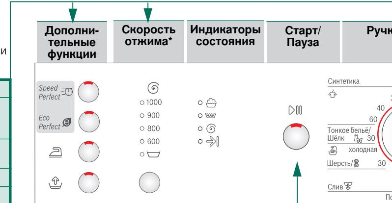
**i** Все клавиши являются высокочувствительными – для их активизации достаточно легкого прикосновения! При продолжительном прикосновении к кнопке установки скорости отжима срабатывает автоматический просмотр опций настройки!
